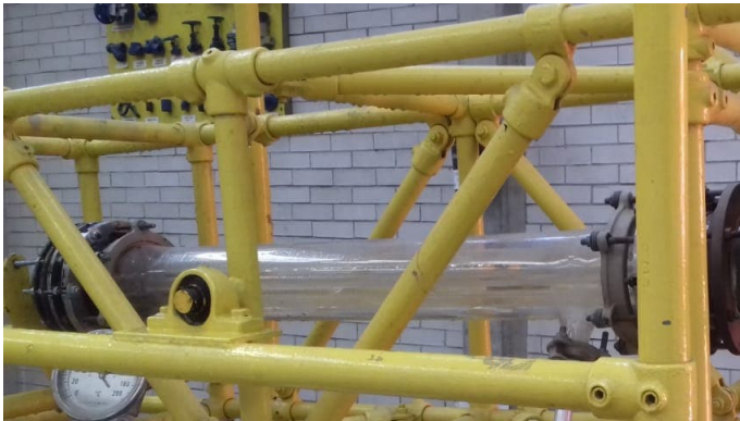
Imagen 1. Sistema de estudio, intercambiador de calor de vidrio de la planta piloto de la FES Zaragoza
