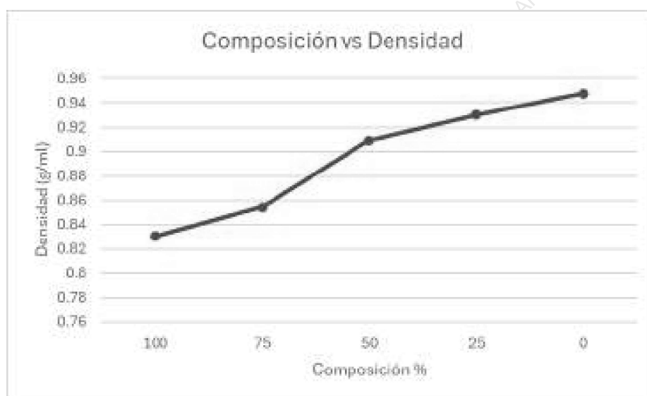
Gráfica 1: Composición contra densidad para el sistema etanol-agua.
