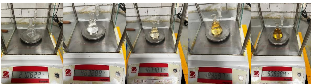
Picnómetro de 50 ml con disoluciones sacarosa-agua
