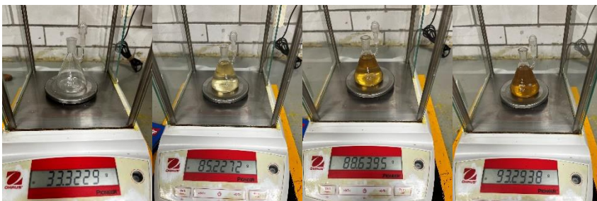
Picnómetro de 50 ml con disoluciones sacarosa-agua
